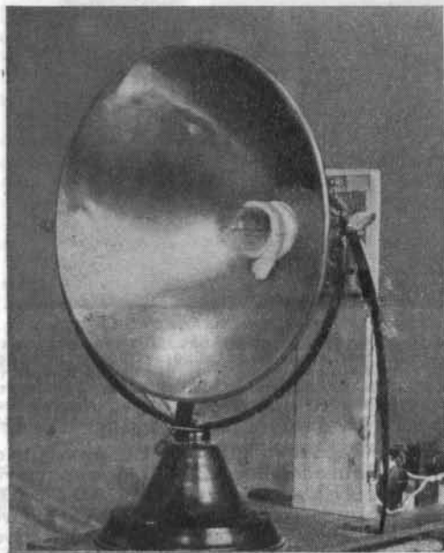
Είκ. 2. Ό μικρός προβολεύς κατευθυνόμενης έκπομπής, μέ λυχνίαν περιέχουσαν την κεραίαν έκπομπής έντός του ύαλίνου περιβλήματος αυτής. Διά μέτρος προβολέως μόνον 37 εκατοστά, βάρος 5 χμγ. Δέσμη 50 εις \lambda=10 cm και 20°30' εις \lambda=5 cm.
